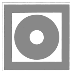
Кнопка включения установок (систем) пожарной автоматики
