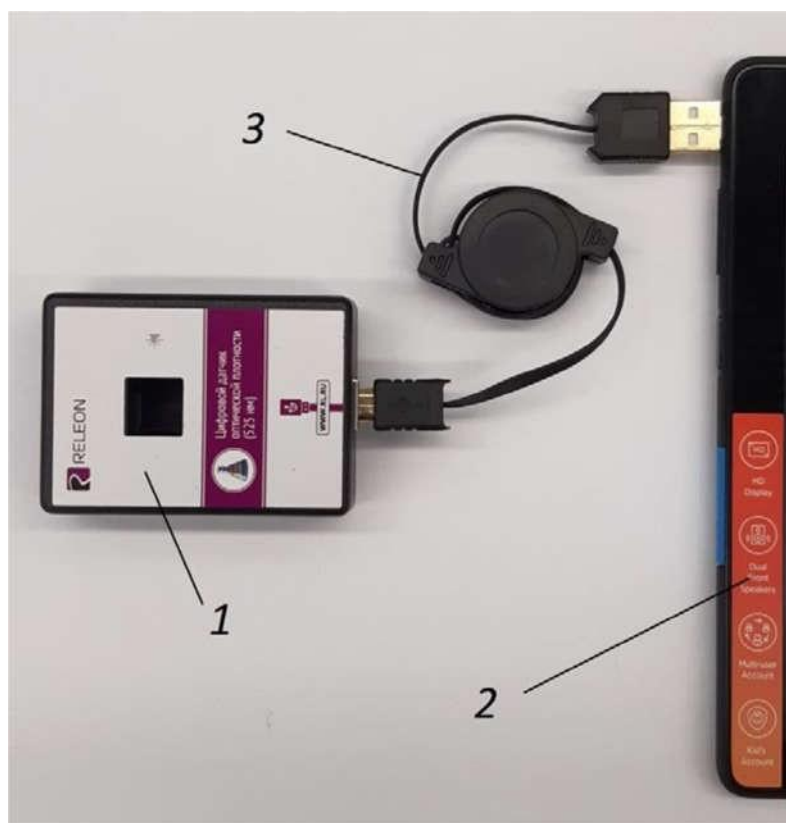
Рис. 19. Монодатчик, подключённый к регистратору данных: 1 — датчик оптической плотности, 2 — регистратор данных (планшетный компьютер), 3 — переходник
