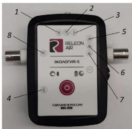
Рис. 3. Мультидатчик по экологии: 1 — освещённость, 2 — относительная влажность воздуха, 3 — температура окружающей среды, 4 — температура растворов, 5 — нитрат-ионы, 6 — хлорид-ионы, 7 — pH , 8 — электропроводность
