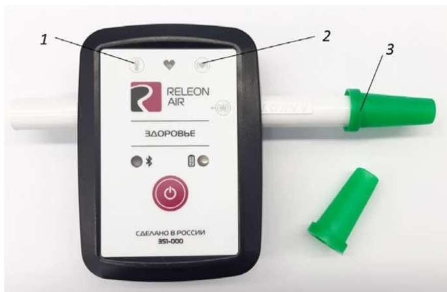
Рис. 3. Мультидатчик по физиологии: 1 — температура тела, 2 — пульс, 3 — частота ды-хания (надет съёмный мундштук)
